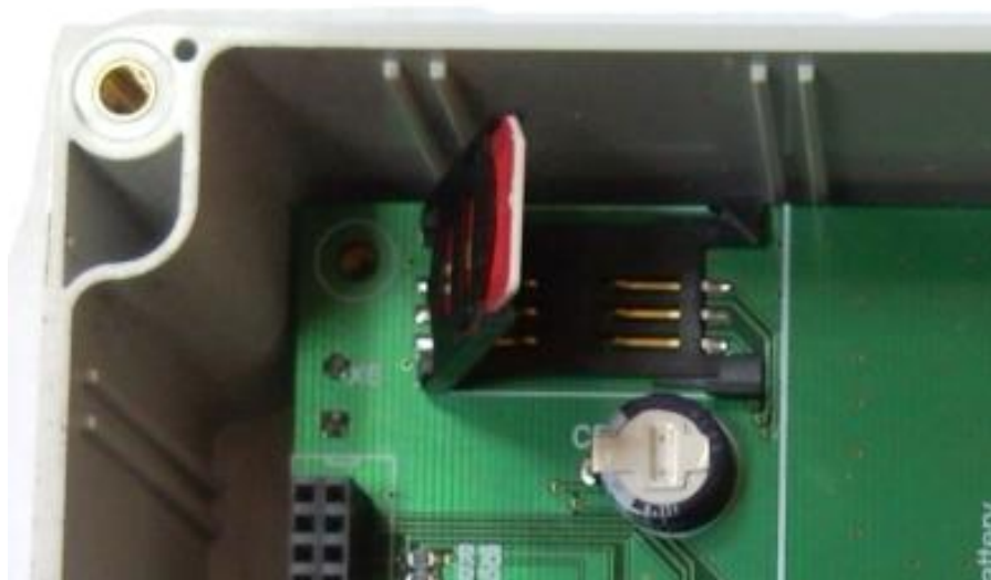
Рисунок 3 – Установка SIM-карты в АСР
